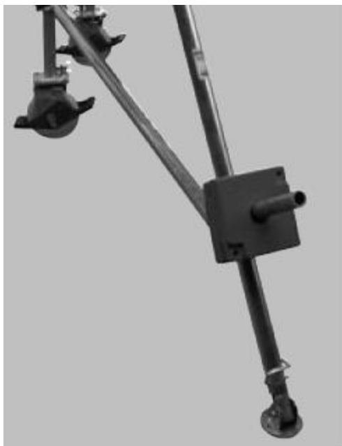
Balastowanie wspornika podpory
